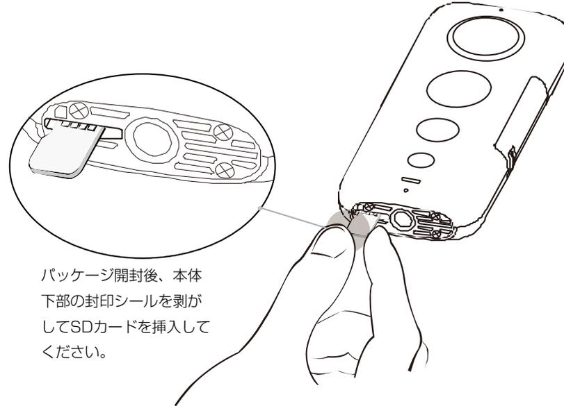
パッケージ開封後、本体下部の封印シールを剥がしてSDカードを挿入してください。
